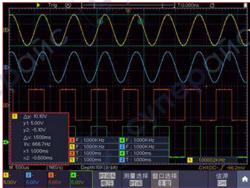
图 4-21：时间&电压光标测量波形
