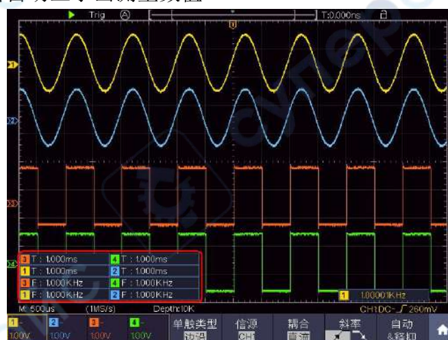
图 7-1：自动测量波形
