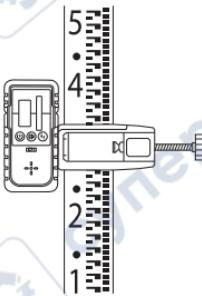
При поиске отметки ослабьте винт крепления и плавно перемещайте адаптер с приемником вверх-вниз по рейке до обнаружения исходной точки.
