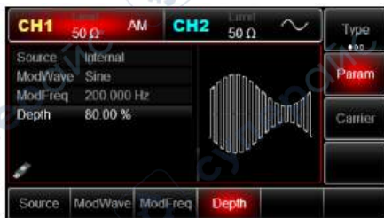
Рис. 27 Амплитудно-модулированный сигнал с глубиной модуляции 80 %
