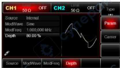
Рис. 74 Установка глубины модуляции в режиме модуляции SUM
