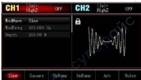
Рис. 8 Выбор модулирующего сигнала
