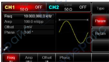
Рис. 33 Выбор параметров несущего сигнала
