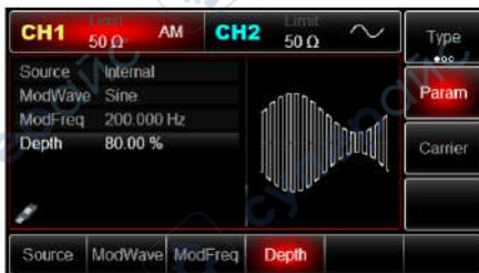
Рис. 27 Амплитудно-модулированный сигнал с глубиной модуляции 80 %
