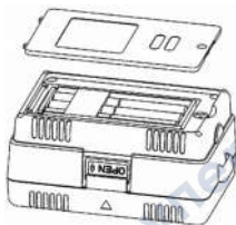
Рис. 5. Установка и замена батарей
