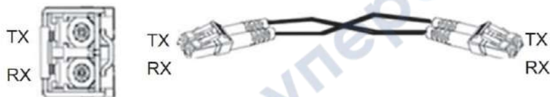
Рисунок 12. Кабельное соединение оптического модуля SFP
