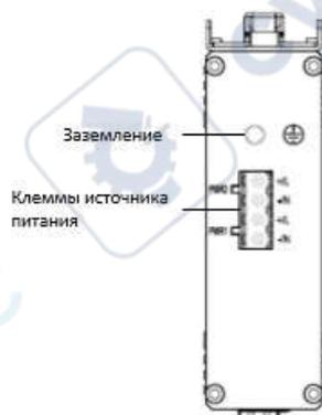
Рисунок 2. Верхняя панель 5-портового коммутатора 10/100 Мбит/с
