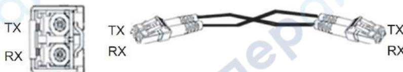
Рисунок 25. Кабельное соединение оптического модуля SFP
