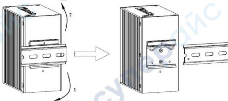
Рисунок 20. Демонтаж с DIN рейки
