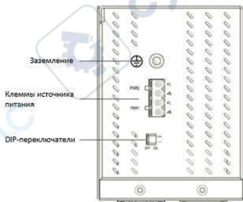
Рисунок 6. Верхняя панель 16 портового коммутатора 10/100 Мбит/с
