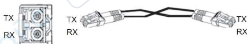
Рис. 11. Кабельное соединение оптического модуля SFP
