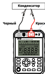
Рис. 9.3.3.1 Проводное подключение измерения емкости
