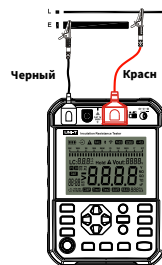
Рис. 9.3.2.1 Проводное подключение измерения напряжения
