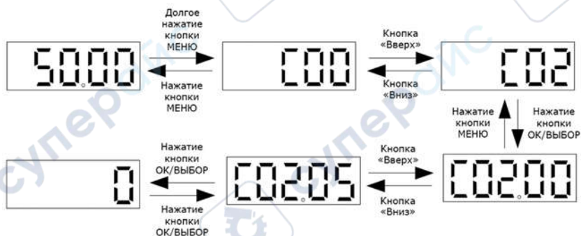
Рисунок 5.5-3. – Основные операции с панелью управления
