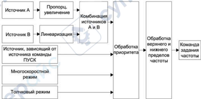
Рисунок 10.5-1. – Схема задания частоты
