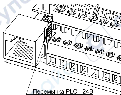
Рисунок 4.7-3. Схема подключения перемычек «+24 В», «PLC», «COM» для мощностей 7,5-22 кВт
