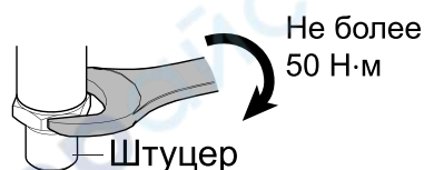
Рисунок 6.7 – Крепление штуцера
