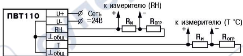
Рисунок 8.2 – Схема подключения (тип выходного сигнала-4-20 мА)
