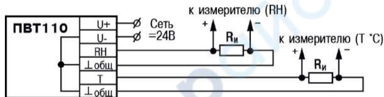
Рисунок 8.3 – Схема подключения (тип выходного сигнала-0-10 В)
