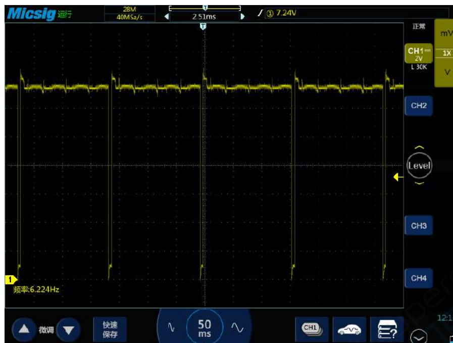
Рис. 21-б. Результаты проверки электромагнитного клапана абсорбера Audi A6.
