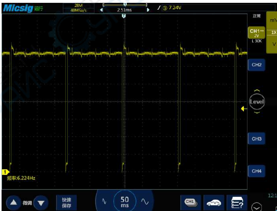
Рис. 21-а. Результаты проверки электромагнитного клапана абсорбера Audi A6.
