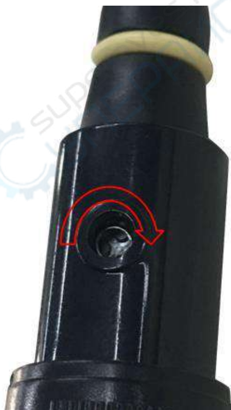
Рис. 13. Регулировка компенсации щупа.
