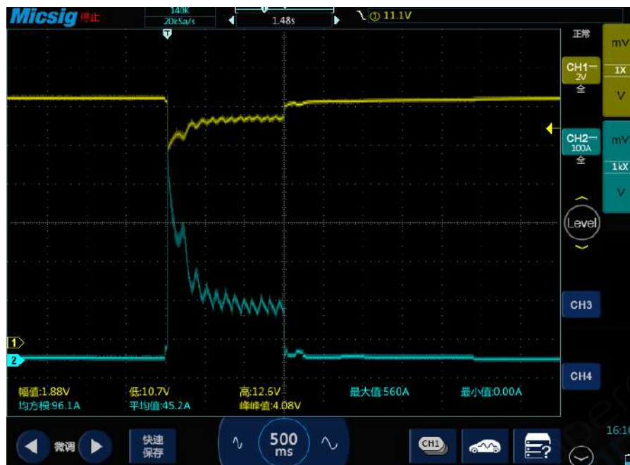
Рис. 16. График пускового тока и напряжения.
