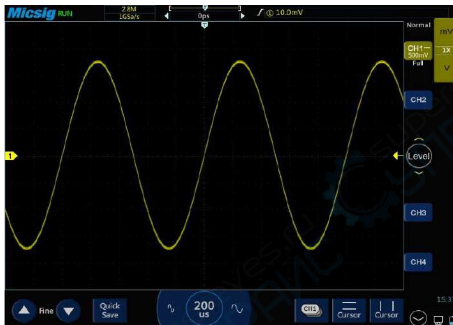
Рис. 8. Осциллограмма, полученная в режиме «Auto Set».
