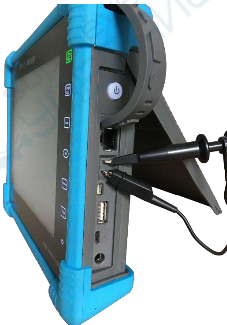
Рис. 11. Подключение щупа для настройки компенсации.
