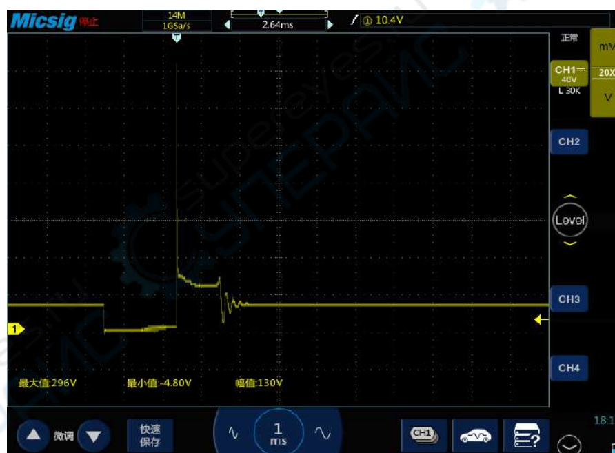
Рис. 23. Пример результатов проверки первичной цепи зажигания.
