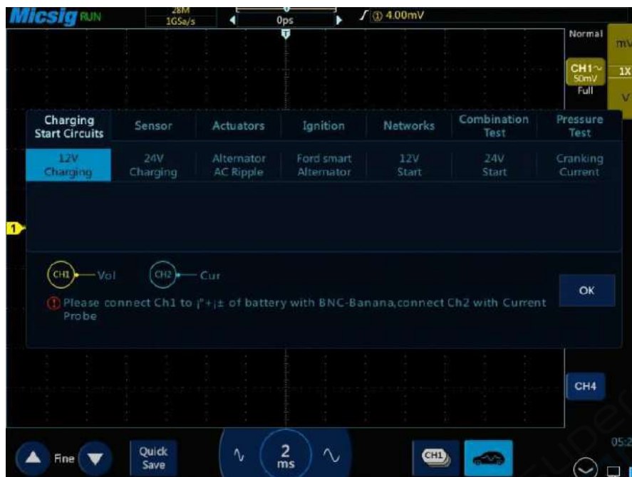
Рис. 14. Проверка генератора 12 В.
