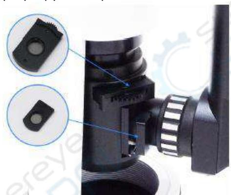
Поляризатор и анализатор (опционально)
