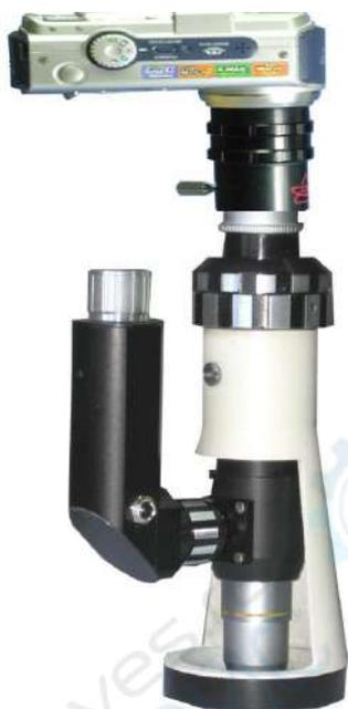
Портативный металлографический микроскоп A13.2501 предназначен для исследования и анализа структуры металлов и сплавов различного типа. Прибор подходит для анализа и контроля структуры металлических материалов в условиях производства или лаборатории. Данный микроскоп также можно использовать для исследования и анализа структуры поверхности нефрита, керамики, бронзы.
