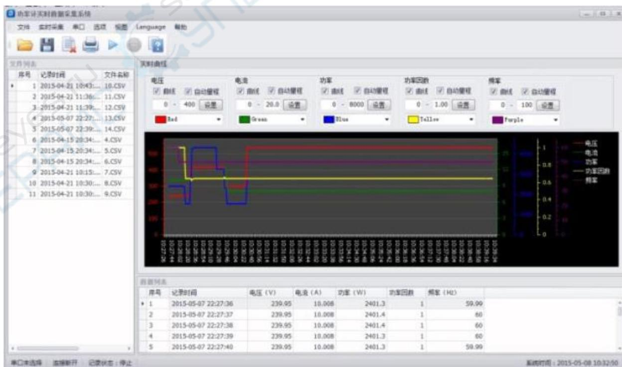
В приложении удобное отображение данных и расширенное меню настроек. Здесь одновременно отображаются список файлов, список параметров, кривые и интерфейс электрических параметров.
