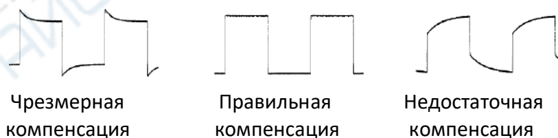
Рисунок 5. Компенсация щупа
