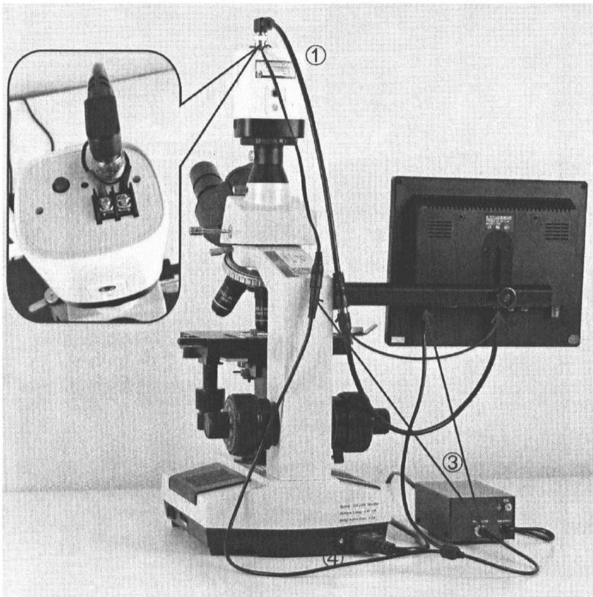
Схема подключения SK2009H2S3
