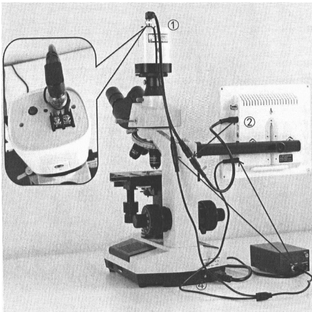
Схема подключения SK2009HS3
