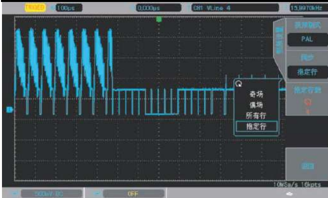
Запуск по синхроимпульсу строки видеосигнала
