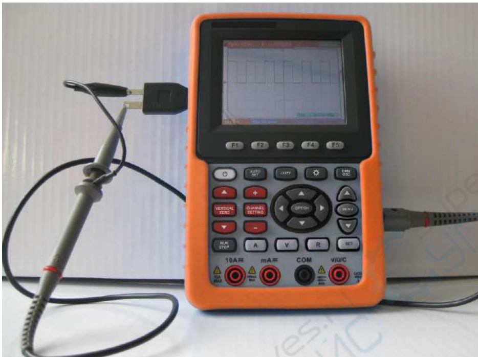
图 3 方波测试信号连接
