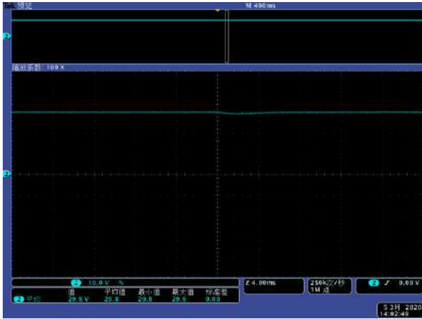
10%到 50%负载变动情况下，动态响应波形
