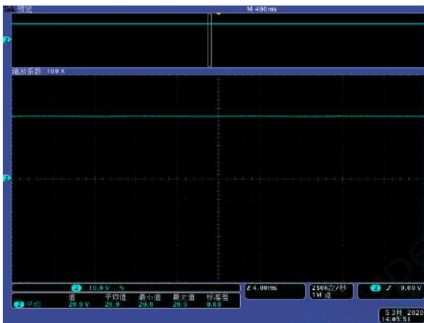
50%到 90%负载变动情况下，动态响应波形
