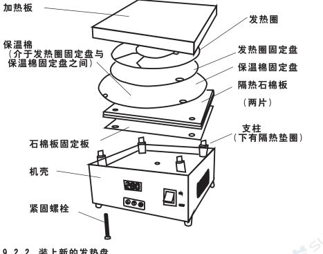
9.2.2 装上新的发热盘 9.2.3 按拆卸的相反程序,重新装上螺丝,固定加热板。
