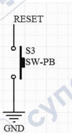
图 4.6 A6/A9/A9G IO 复位电路参考设计
