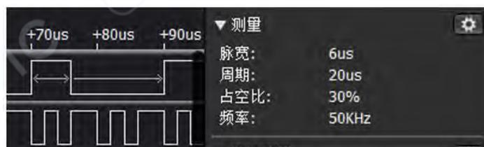
Как показано на рисунке выше, при перемещении курсора в верхний канал в область положительного импульса, появится стрелочка. Справа в окне отображения измерений можно увидеть следующие параметры: ширина импульса: 6 мкс, полный цикл: 20 мкс, коэффициент заполнения: 30%, частота: 50 кГц.
