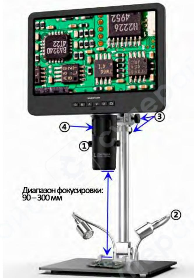
Микроскоп с линзой L
