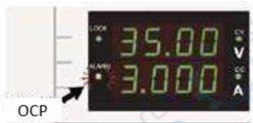
При входе в состояние защиты (прибор обеспечивает три защитных функции: OVP - превышения напряжения, OCP - превышение тока, ONP - перегрев) отключится выход, включится светодиод ALARM (сигнализация), дисплей покажет причины неисправности и будет выдан сигнал тревоги с контакта №13, соединённого с J1. OCP (защита от превышения тока) включена. Отображается сигнализация.
