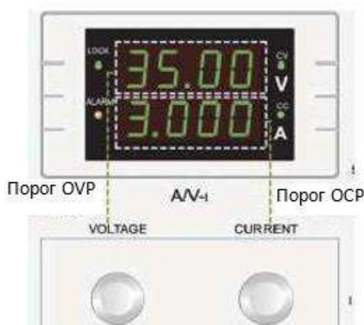
Когда блок питания в нормальном состоянии (выход отключён), нажмите кнопку (OVP/OCP), на дисплее отобразятся ранее установленные пороговые значения OVP / OCP:
