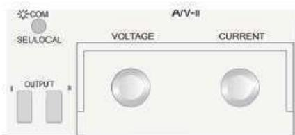
Для изменения величины напряжения вращайте поворотную ручку «voltage». Для изменения величины тока вращайте поворотную ручку «current». Значения могут изменяться независимо от состояния «включен» или «выключен» (ON/OFF) выхода (output).
