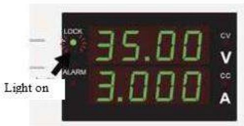
Чтобы предотвратить неправильную работу пользователя, прибор имеет функцию блокировки панели управления.
