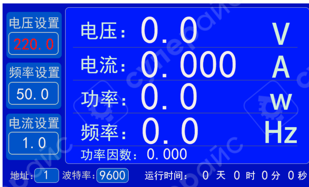
Рисунок 3 — Режим установки напряжения
