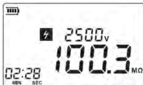
4. Отпустите кнопку — прибор автоматически разрядит высокое напряжение, индикатор высокого напряжения и звуковой сигнал отключатся. Снимайте тестовые провода только при отображении на дисплее «0V». На экране также отобразится время теста и измеренное сопротивление изоляции.
