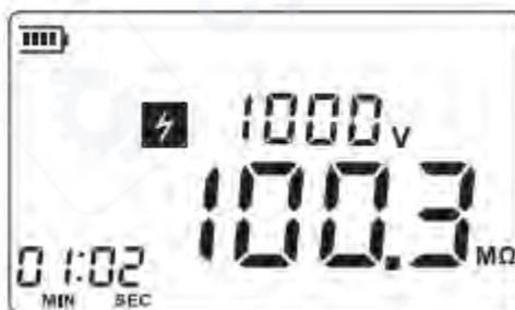
После завершения измерения поверните клавишу тестирования обратно против часовой стрелки в исходное положение. Прибор автоматически разрядит высокое напряжение, индикатор высокого напряжения и звуковой сигнал отключатся. Снимайте тестовые провода только после того, как на дисплее появится показание «0V».
