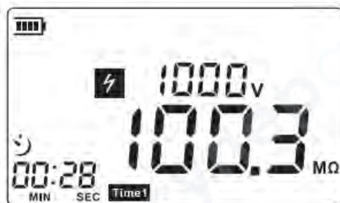
5. Измерение автоматически завершится по истечении заданного времени, индикатор высокого напряжения погаснет, звуковой сигнал прекратится. Поверните кнопку теста обратно против часовой стрелки в исходное положение. На дисплее отобразится соответствующая информация.
