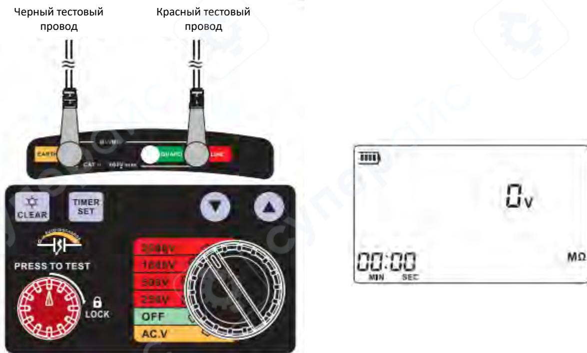
3. Подсоедините щупы / зажимы к проверяемому устройству. Нажмите кнопку **TEST** для начала измерения. Звучит зуммер и включается индикатор высокого напряжения. ЖК-дисплей отобразит текущие значения.
