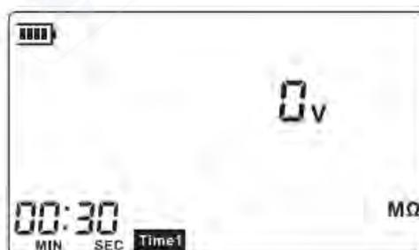
4. Нажмите и поверните кнопку PRESS TO TEST по часовой стрелке для запуска таймерного измерения сопротивления изоляции. Звучит зуммер, индикатор **Time1** начнёт мигать, а на дисплее появятся данные измерения.
