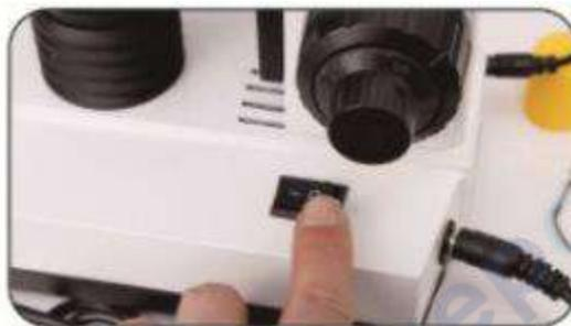
5. Долго удерживайте кнопку S, чтобы начать нагрев (по умолчанию 38° при включении), однократно повторно нажмите кнопку S, чтобы войти в режим установки температуры. Нажимайте «+» и «-», чтобы установить температуру.
