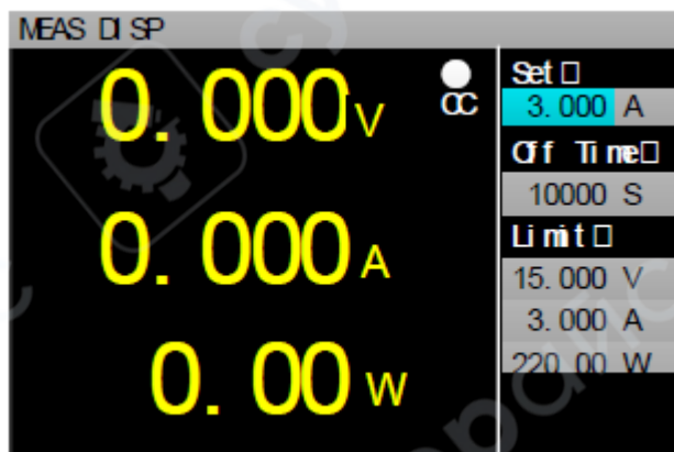
Рисунок 7 Режим постоянного тока
