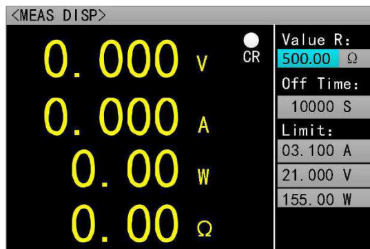
Рисунок 6.6.3. Режим стабилизации сопротивления
