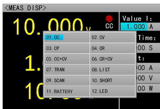
Рисунок 6.6. Активация режима стабилизации тока
