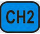
— Используется для управления выходом CH2, а также для перехода в меню настройки CH2. <ul style="list-style-type: none"> <li>— При нажатии этой кнопки, канал CH2 включается (индикатор загорается), этот разъем выводит сигнал с текущими настройками канала CH2.</li> <li>— При повторном нажатии данной кнопки, канал CH2 выключится, индикатор погаснет.</li> </ul> |
