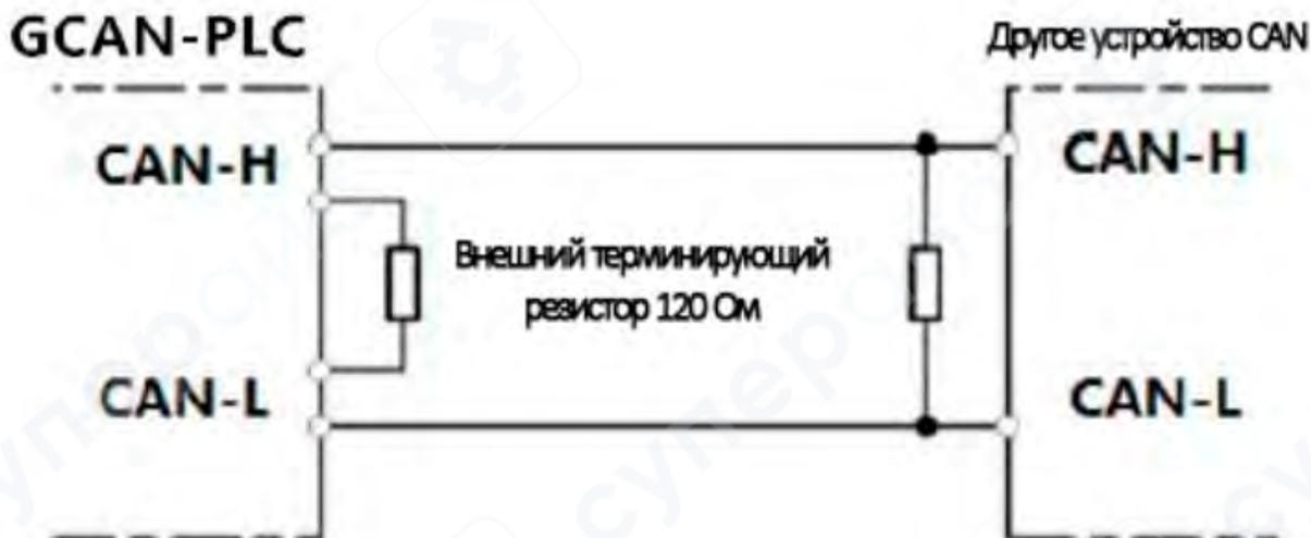
Рисунок 2.2 – Подключение GCAN-PLC-320/321/322 к другим устройствам в сети CAN с внешними терминирующими резисторами 120 Ом
