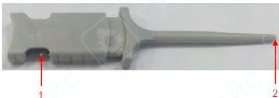
1. Подключите сигнальный кабель логического анализатора к металлическому терминалу.
