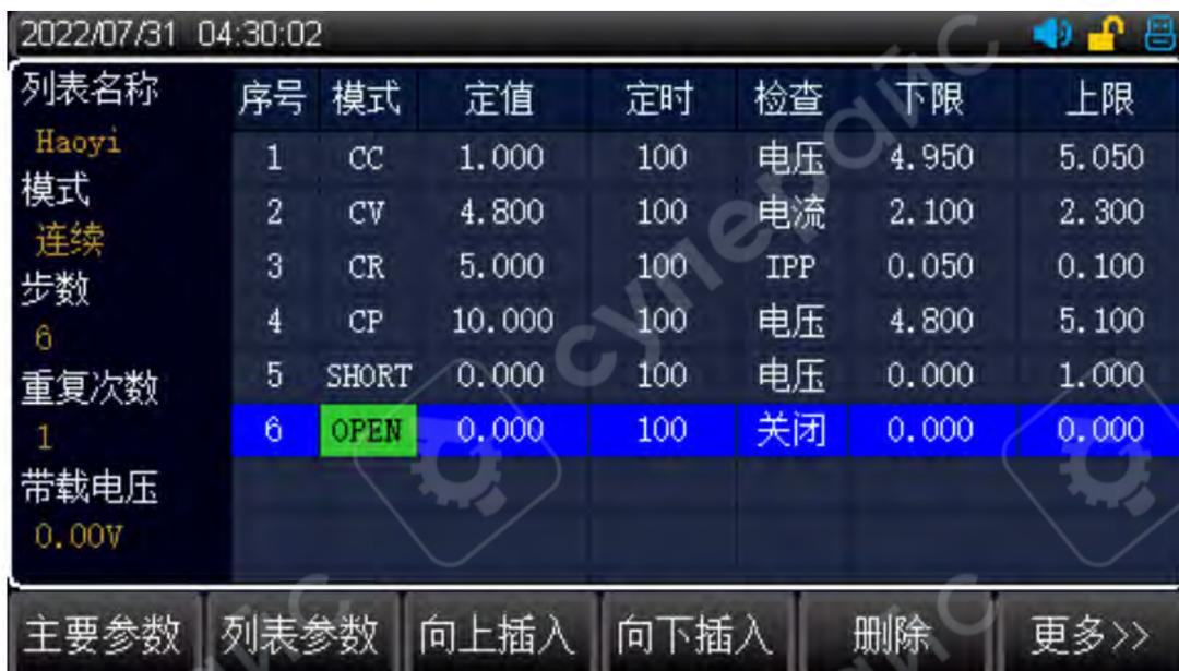
Рисунок 16 - Интерфейс настройки автоматического списочного теста
