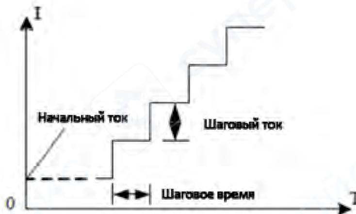
Рисунок 21 - Режим теста перегрузки
