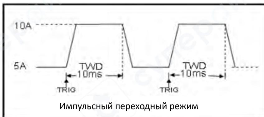
Рисунок 14 - Импульсный режим динамической работы
