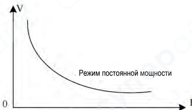
Рисунок 11 — Диаграмма I-V режима постоянной мощности СР
