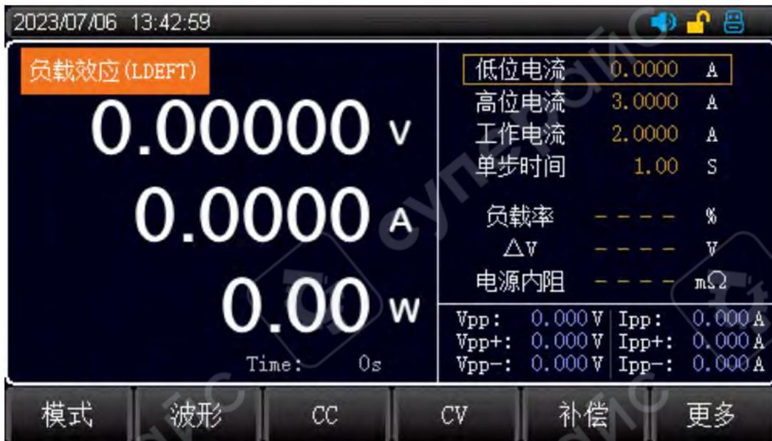
Рисунок 27 - Интерфейс тестирования нагрузочного эффекта
