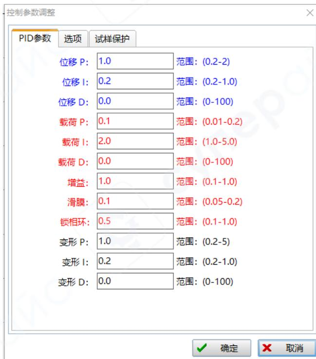
Пользователь устанавливает параметры ПИД-регулятора в данных пределах (подходят для материалов с высокой жесткостью). Чтобы сохранить параметры настройки, нажмите кнопку «Подтвердить».
