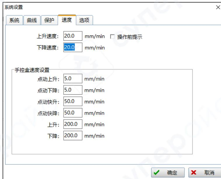
✧ Скорость подъема: после нажатия кнопки «Подъем» устройство движется вверх с установленной скоростью.
