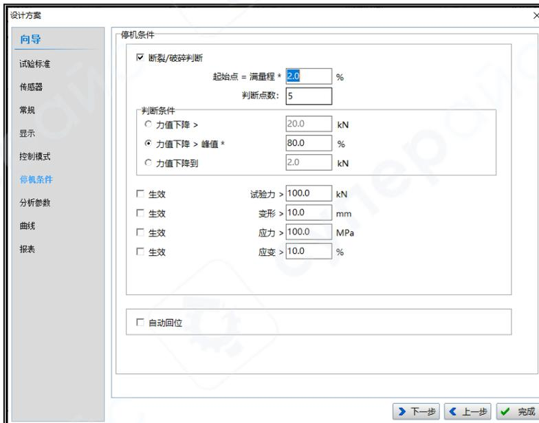
✧ Заключение о разрыве/разрушении: при выполнении условий разрушения образца приложение автоматически завершает испытание.
