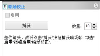
一些 CMOS 和非制冷的 CCD 在较长曝光时间或者较大增益时, 能看到不少热噪声, 严重影响图像的清晰度。使用**暗场校正**可以在一定程度上减少这个问题, 从而得到清晰干净的画面。使暗视场校正, 需先捕获暗场图像, **启用**按钮才激活。选择表示**启用**。不选择则是取消**暗场校正**。
