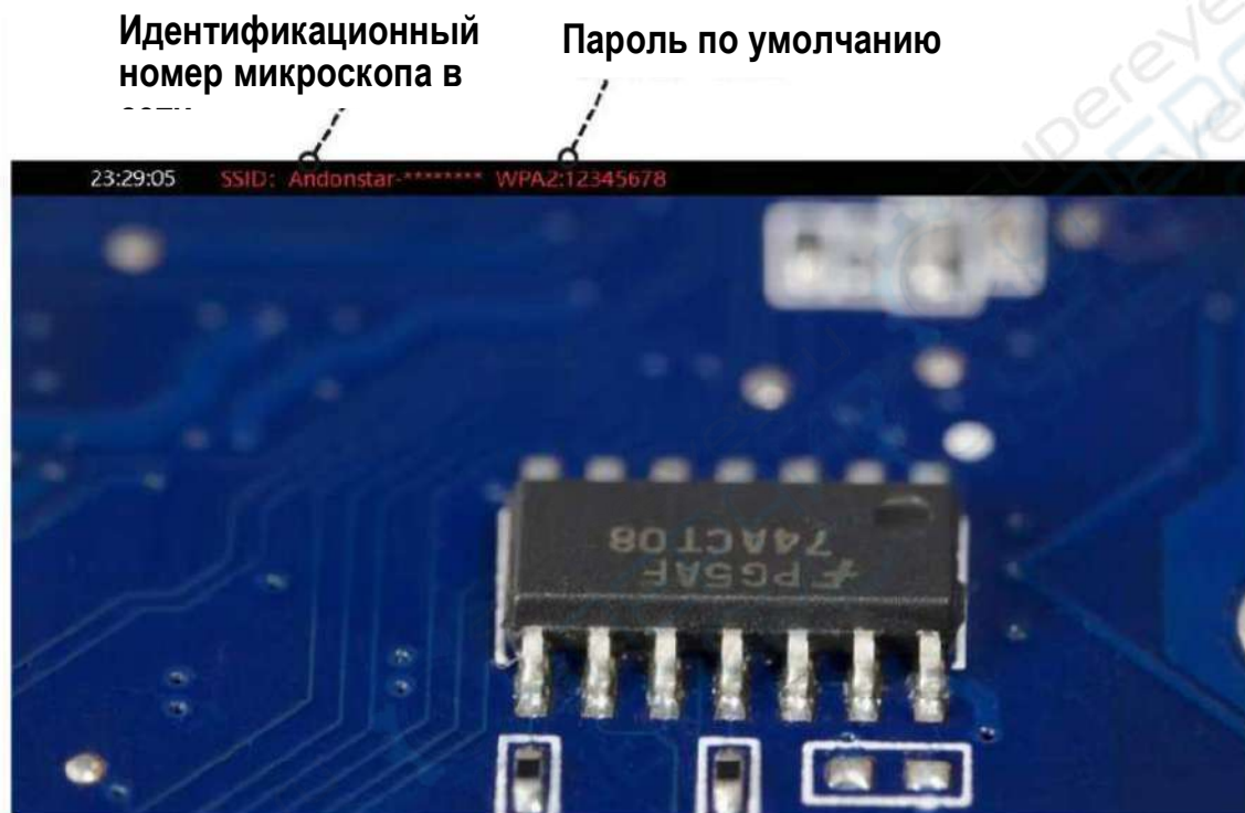
Рисунок 9 — Экран микроскопа после успешного подключения к WiFi
