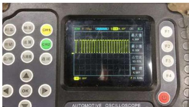
气流量转换成频率信号。当频率信号愈高，代表空气量愈大。启动发动机，此时会在屏幕上显示出方波图形，若无任何波形显示。
