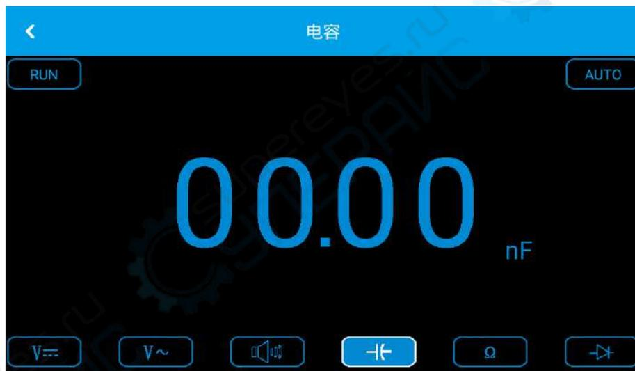
②把测量表笔连接到待测电容两端，即可读出显示值。
