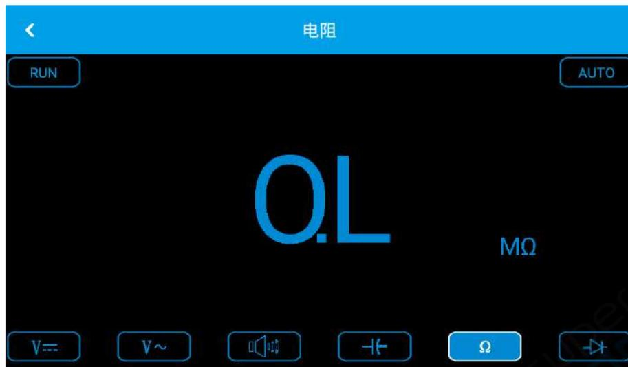
②把测量表笔连接到待测电阻两端，即可读出显示值，如需要也可手动设置量程。
