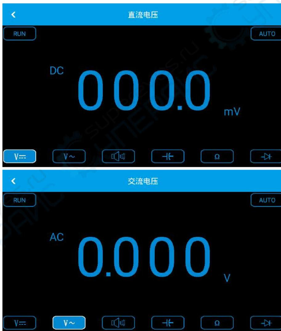
④ 将测试笔连接到待测电压或电源上，便可读出显示值。同时，红色表笔所接端的极性也可通过液晶显示器显示值的正、负看出。（测交流电压时无极性显示）本仪器默认为“自动”量程，如需手动设置量程，可通过点击“**AUTO**”图标来改变量程，然后进行测量。
