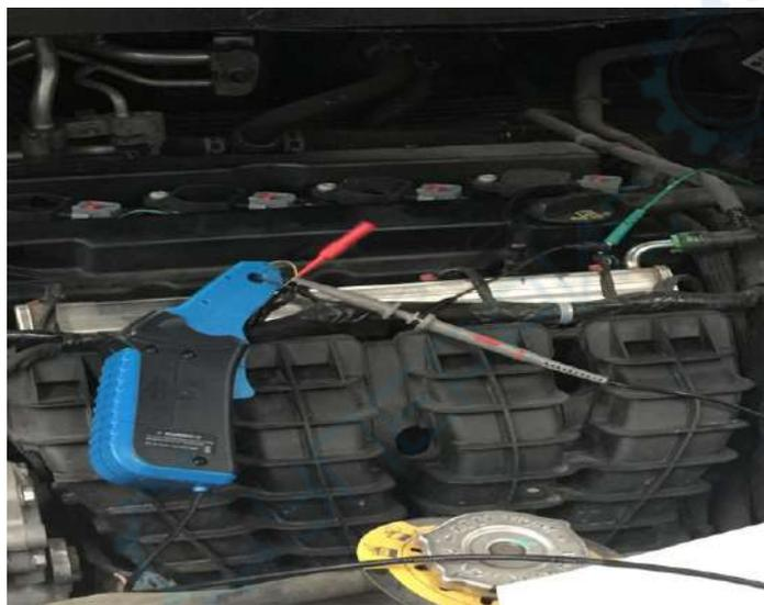
图7 电流钳的使用方式
