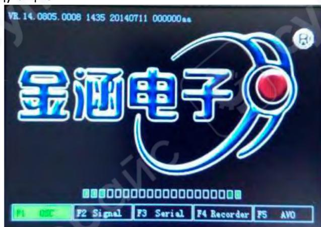
2. На экране загрузки выберите рабочий режим прибора, нажав кнопки F1 ~ F5. По умолчанию выбран режим "осциллограф", и примерно через 3 секунды автоматически откроется интерфейс работы осциллографа.
