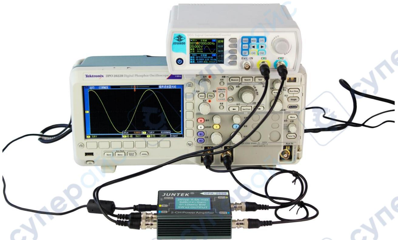
Выходной сигнал напряжения с генератора сигналов подключается к входу усилителя мощности, расположенному с левой стороны.
