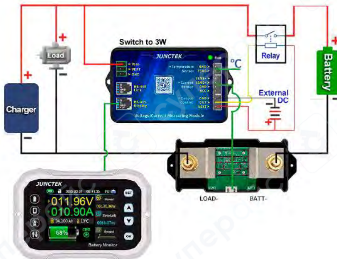
Схема подключения реле с внешним питанием (пример для КН140F).
