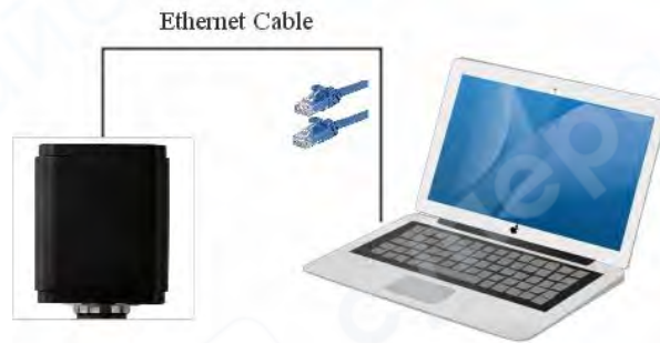
图 10 X7CAM4K 系列相机通过 LAN 接口连接到电脑
