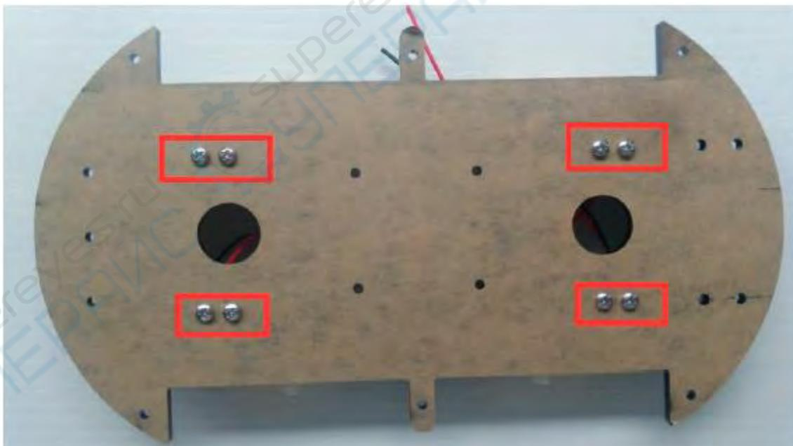
Рисунок 3. Крепежный винт для двигателя
