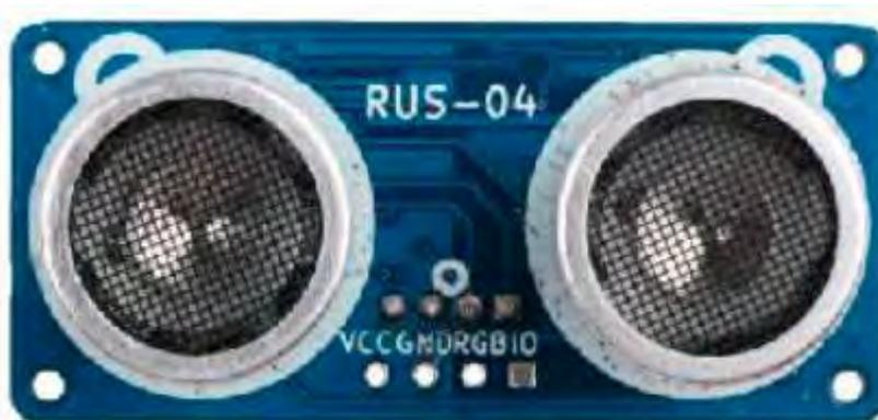
Модуль ультразвукового обхода препятствий представляет собой устройство, преобразующее другие виды энергии в ультразвуковую энергию нужной частоты или другие виды энергии, преобразующие ультразвуковую энергию в ту же частоту.
