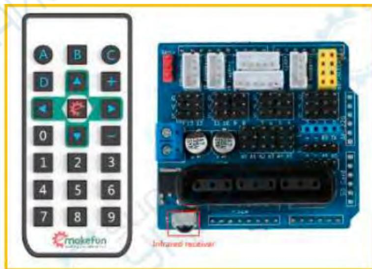
В Hummer-Bot встроенный инфракрасный приемник имеет три контакта, включая контакт питания, заземление и выход сигнала.
