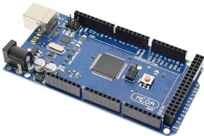
Каждому оркестру нужен дирижер. Дирижер нашего оркестра датчиков и актуаторов - микроконтроллер (по-другому контроллер, плата) Arduino Mega.
