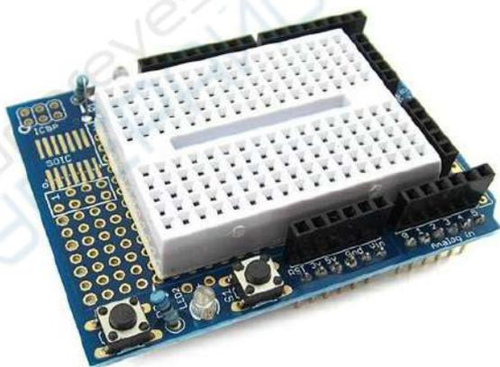
**Шилд (Shield)** - это способ прокачать Arduino. Каждый шилд даёт какую-нибудь супер-способность. Например, есть **Motor-shield**, который позволяет без проблем подключить моторы, есть **Ethernet-shield**, который соединяет плату с Интернетом, есть **Prototype-shield**, который ускоряет время сборки прототипов устройств в разы, много всякого есть.
