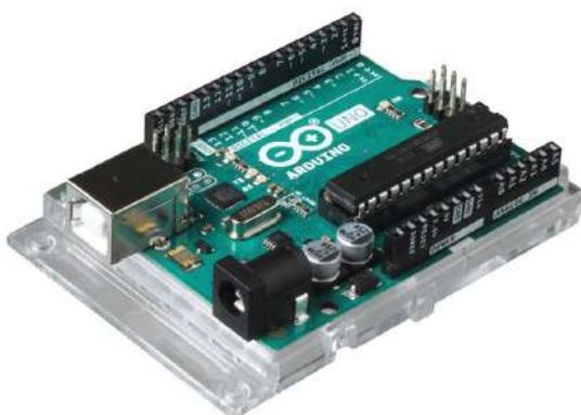
Штука, вокруг которой мы и будем крутиться. **Arduino Uno** считывает показания сенсоров, управляет актуаторами и делится результатами с людьми. Arduino Uno часто называют по-разному. Контроллер, плата, микроконтроллер - это всё про Arduino Uno.
