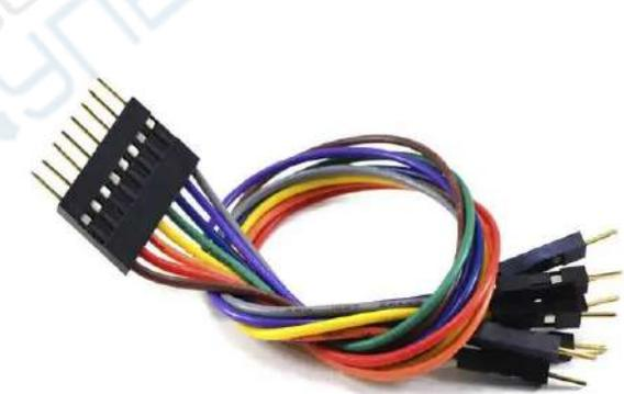
**Провода и соединители** помогут подключить сенсоры и актуаторы к Arduino. Под разные типы соединений идут разные провода. В Arduino Uno используются соединения 2.54 мм. Их также называют **пинами**.
