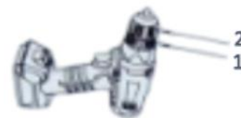
1. Регулировочное кольцо 2. Направляющая втулка
