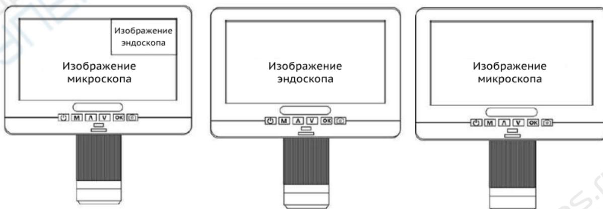
(Рисунок 10 - Схематическая диаграмма процесса переключения экрана)
