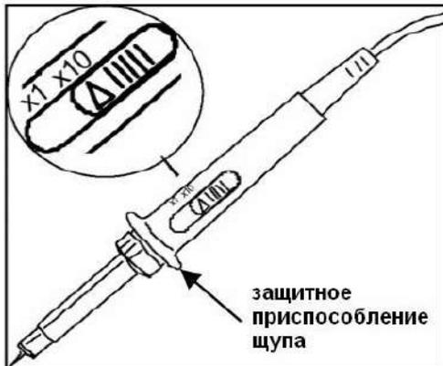
Рисунок 1-6. Щуп осциллографа
