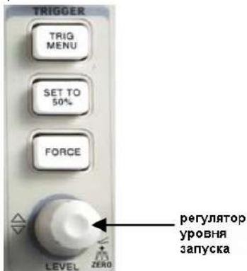
Рисунок 2-28. Кнопки и регулятор управления системой запуска
